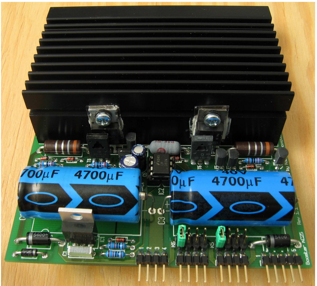
Booster KC25 – über die beiden grünen Jumper können Sie die Zuordnung der vier möglichen Boosterstromkreise einstellen
